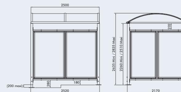
Poteaux carrés en tube acier 80 x 80 mm sur platines
