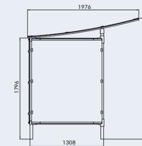
Structure en tube aluminium anodisé de Ø 50 mm
