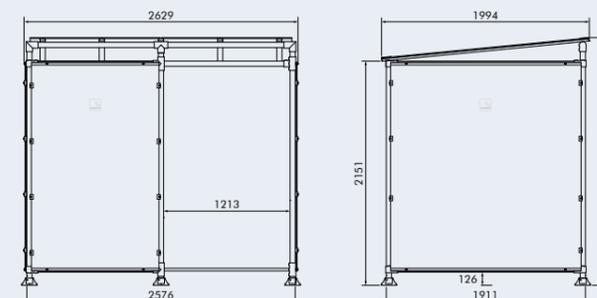
Structure en tube aluminium anodisé Ø 50 mm sur platines
