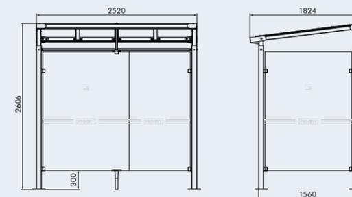
Poteaux carrés en tube acier 80 x 80 mm sur platines
