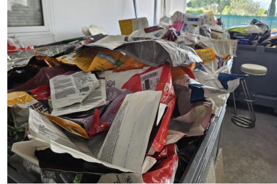
3. Collecte des sacs pour la fabrication des panneaux d'habillage
