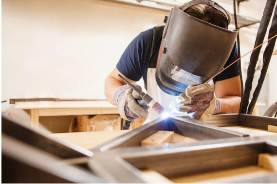
1. Soudure des profilés en acier dans nos ateliers
