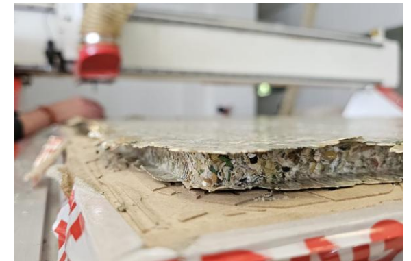
5. Découpe à la forme souhaitée des panneaux via fraiseuse industrielle
