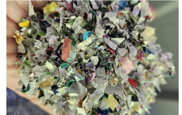
4. Broyage des sacs collectés et compactage dans nos ateliers (filère label ADEME)
