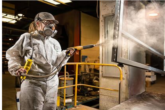
2. Thermolaquage des cadres RAL 9007 avec sous couche anti-corrosion
